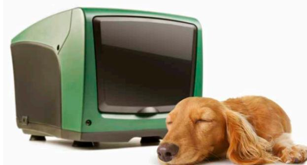
La especial refrigeración por agua del motor, el inverter, la carcasa con características fonoabsorbentes, y los pies anti-vibraciones hacen del e.sybox mini<sup>3</sup> el segundo grupo de presión más silencioso del mercado tras su hermano mayor e.sybox.
