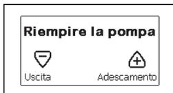
Premendo "+" questo entra nella procedura di adescamento: inizia a lavorare per un tempo massimo di 5 minuti durante i quali il blocco di sicurezza per marcia a secco non interviene. Il tempo di adescamento dipende da diversi parametri, i più influenti dei quali sono la profondità del livello
