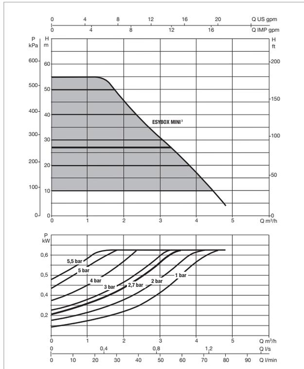
Die Kurven basieren auf einer Viskosität = 1 mm<sup>2</sup>/s und einer äquivalenten Dichte von 1000kg/m<sup>3</sup>. Toleranz der Kurven gem. ISO 9906.
