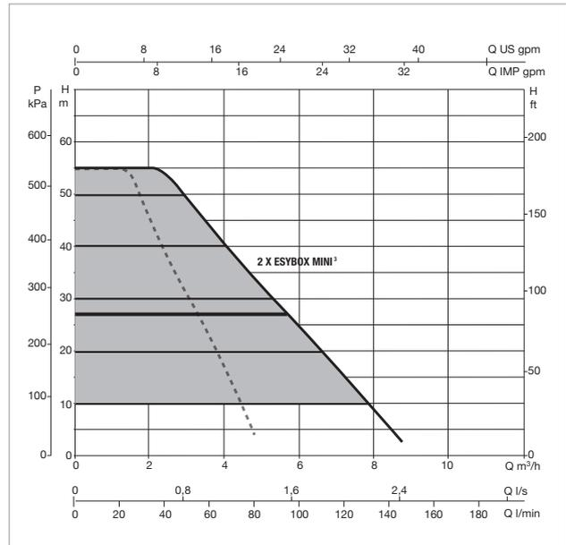
Die Kurven basieren auf einer Viskosität = 1 mm<sup>2</sup>/s und einer äquivalenten Dichte von 1000kg/m<sup>3</sup>. Toleranz der Kurven gem. ISO 9906.
